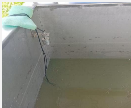
រូបភាព ២២. ឧបករណ៍ធ្វើទឹកត្រជាក់នៃប្រព័ន្ធត្រជាក់ (ក) និងឧបករណ៍ចាប់សញ្ញាសម្រាប់គ្រប់គ្រងសីតុណ្ហភាពទឹក (ខ)
