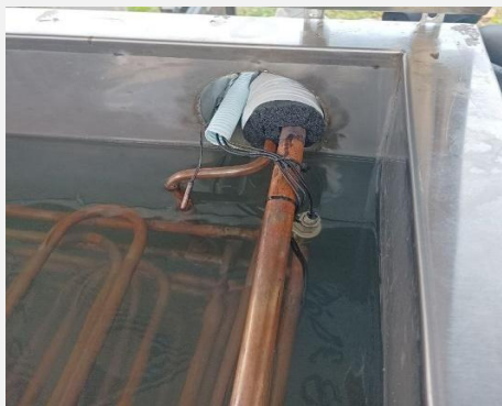
រូបភាព ២២. ឧបករណ៍ធ្វើទឹកត្រជាក់នៃប្រព័ន្ធត្រជាក់ (ក) និងឧបករណ៍ចាប់សញ្ញាសម្រាប់គ្រប់គ្រងសីតុណ្ហភាពទឹក (ខ)
